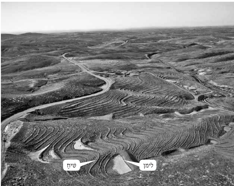
איור 1: מערכת קצירי נגר הבנויה מלימנים ושיחים
