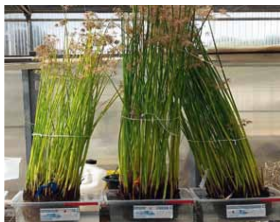
תמונה 4: מערכת הידרופונית, עם מכילים בנפח 20 ליטר, המדמה את האגן הירוק בהוד השרון, ישראל. בתמונה מוצגת המערכת שבה צמחי גומא הפרקים ( Cyperus atriculatus L.) פעילים בהרחקת BPA מתמיסות מימיות ומזהם.
