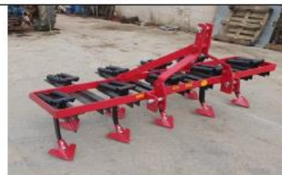
קלטרת קפיצים 9 רגליים עם כפות מסוג כף אווץ (להבי עיבוד בצורת כפות אווץ ובנפיות המשמשים לחיתוך שורשים).
