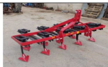
קלטרת קפיצים 9 רגליים עם כפות מסוג כף אווז (להבי עיבוד בצורת כפות אווז וכנפיות המשמשים לחיתוך שורשים).
