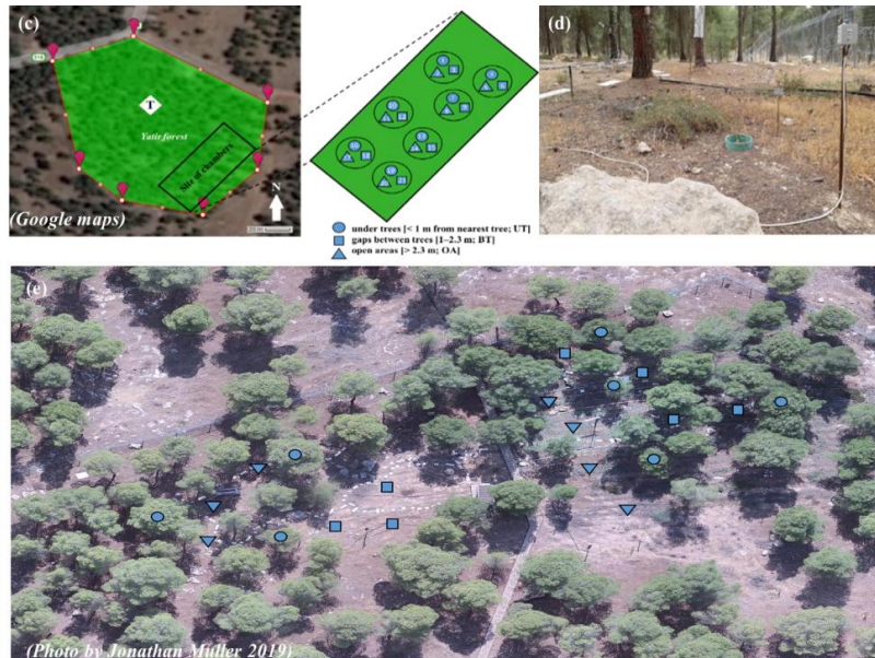
איור 1: חלקות מדידה לחות קרקע ביער יתיר הבוללת שלושה מיקומים שונים לחיישנים: (1) מתחת לעץ, (2) בשטח הפתוח (3) ברווחים בין העצים. עומק החיישנים כולל 0, 20, 30, 40 ס"מ.
